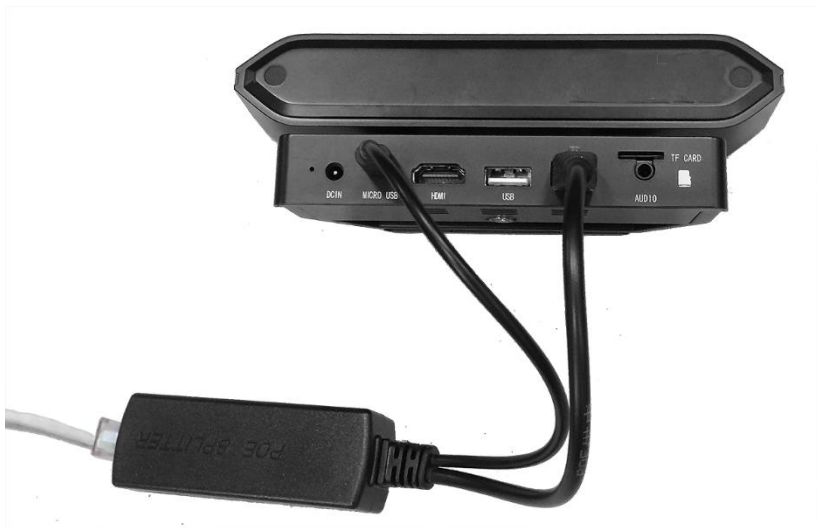
Рисунок 3. Подключения устройства по технологии PoE
