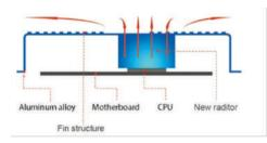
При 100% нагрузке, температура на 20-30°С ниже, чем при традиционной системе охлаждения
