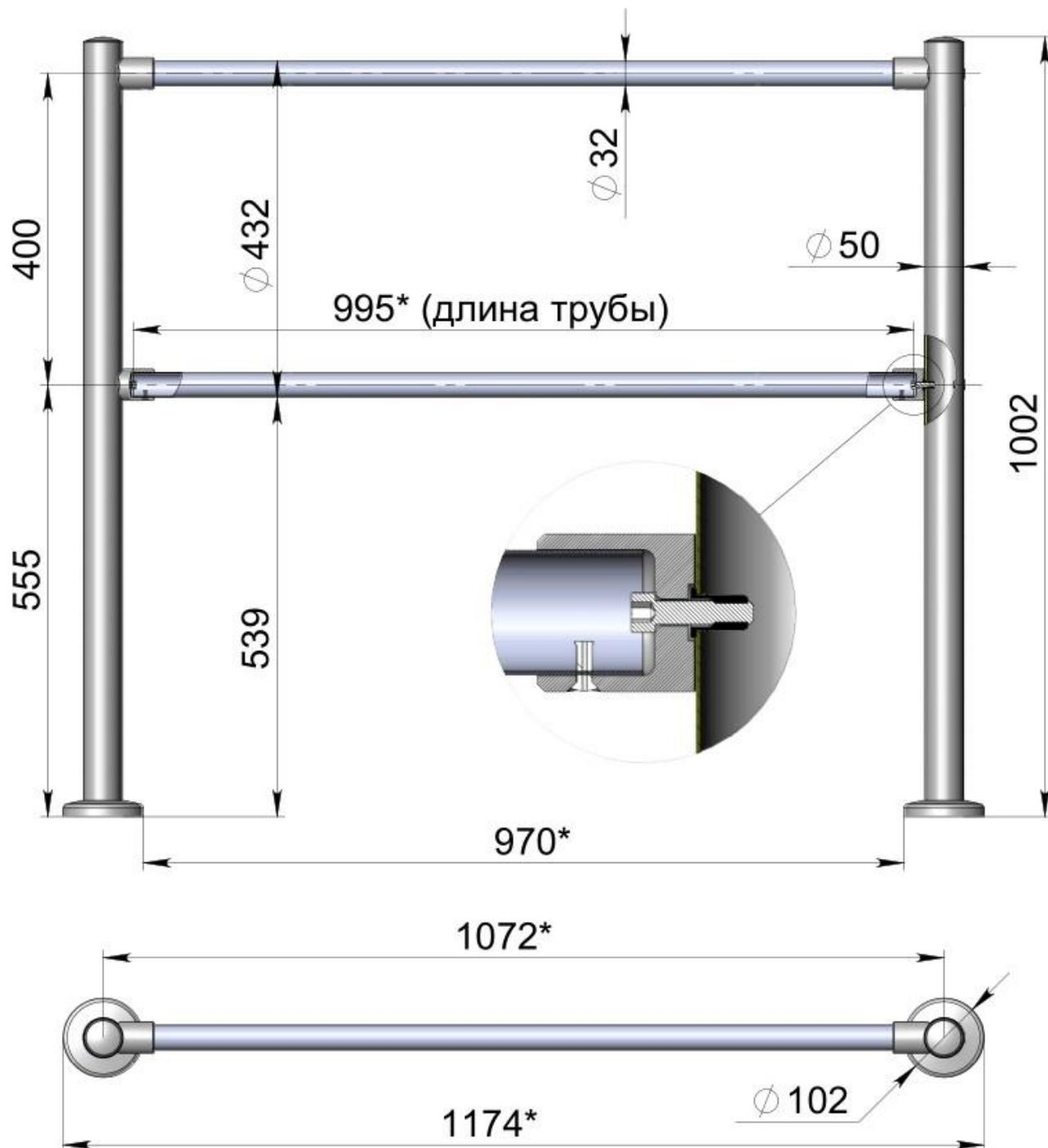
Ограждение с обычными поручнями. Размеры указаны для комплекта поручней 1,0м. Для комплекта 1,5м добавить к размерам \*500мм, для комплекта 0,5м отнять 500мм.
