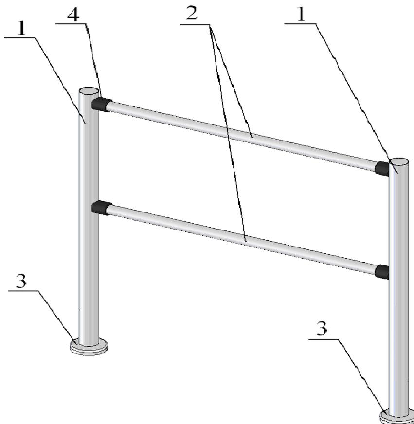
*1 – Хромированная вертикальная стойка диаметром 50 мм,
