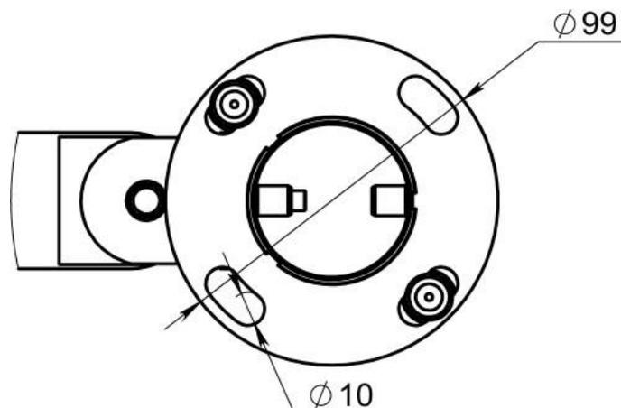
*Вид снизу на стойку ограждения со стороны фланца крепления к полу. Показаны пазы регулировки стойки ограждения.*
