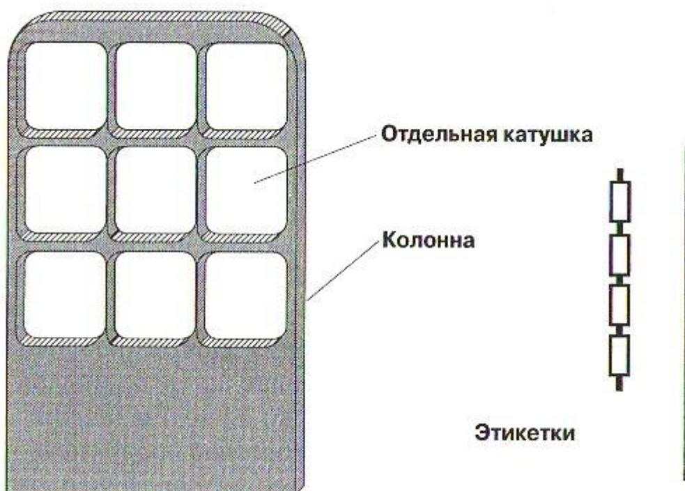
Рис. 6. Слева – типичная конструкция антенны противокражной системы Электромагнитной технологии. Высота приблизительно 1.5 м.; Справа – возможные конструкции этикеток.
