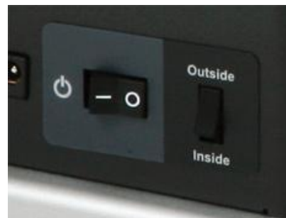
Переключатель для намотки этикеток "внутри или наружу"
